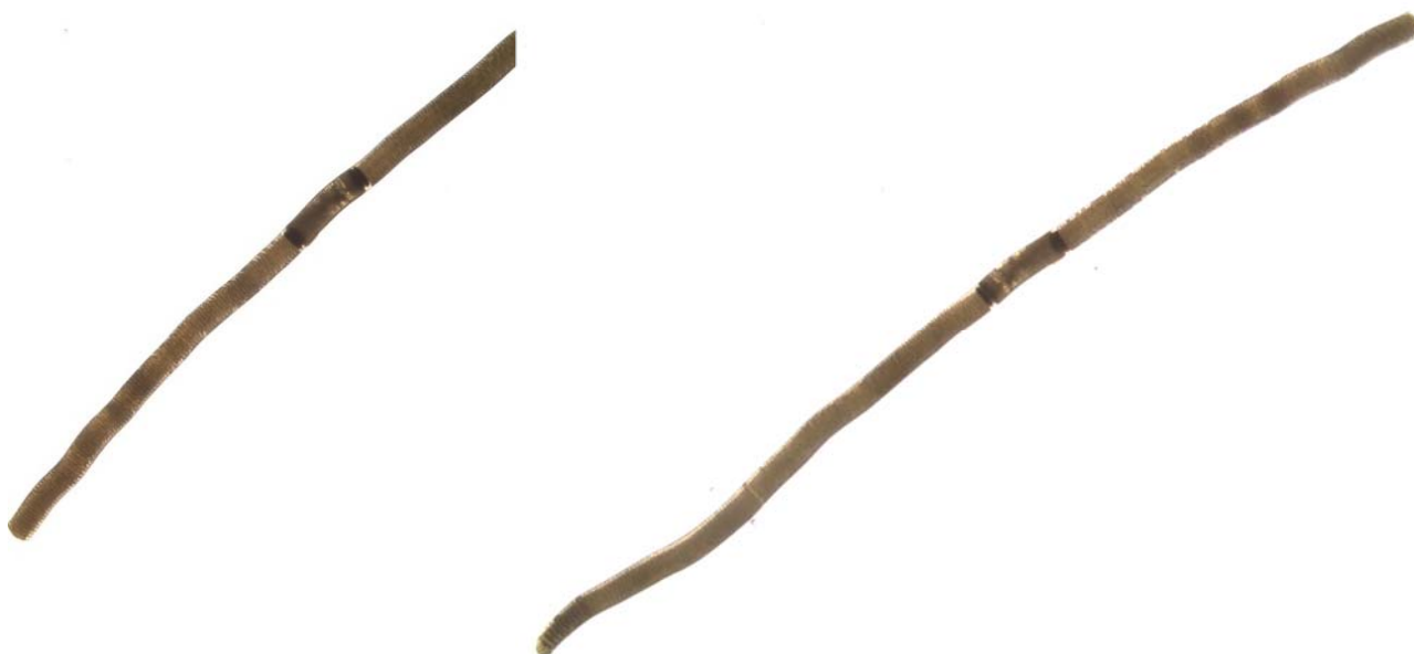
Figur 6: Bilder av eggstrenger før (venstre) og etter (høyre) eksponering for 6 kHz med et lydtrykk på 179dB i 15 minutter.
